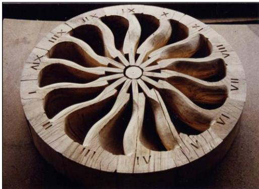
**Figure 4.** Roue de moulin à axe vertical, construite en 1994 par J-M Abadie. Elle n'est ni installée dans son axe, ni cerclée (75 cm de diamètre, 15 cm d'épaisseur). Photo : F. Bordes.
